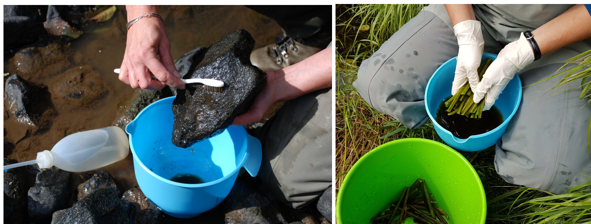
Figur 16. Vid kiselalgsprovtagning hämtas minst fem slumpvis valda stenar från en representativ sträcka av vattendraget, varefter kiselalger och övrig påväxt borstas av från stenarna med en ren tandborste. Materialet sköljs av och samlas upp i en vanna/bunke. Det blandas noga och hålls sedan i burkar, som förvaras svalt och mörkt. Efter att materialet i burken har sedimenterat hålls större delen av vätskan av och ersätts med etanol. Om stenar inte finns på lokalen läggs delar av friska vattenväxter i en burk eller bunke med åvatten. Burken skakas kraftigt (alternativt tvättas växtdelarna av för hand), så att kiselalger och annan påväxt lossnar, varefter vattenväxterna kramas ur och avlägsnas. Proceduren upprepas tills vattnet är mörkt brunt (foto: Medins Havs- och Vattenkonsulter AB).
